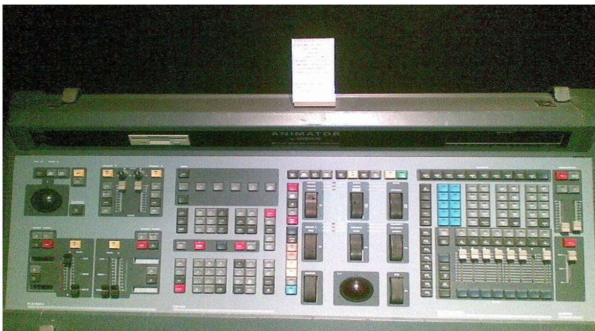
Fig.39.Compulite Animator,primeira console a utilizar o protocolo DMX 512, 1990
